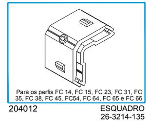
Fresagem necessária, no caso, de aplicação do perfil FC 38, de forma contínua
