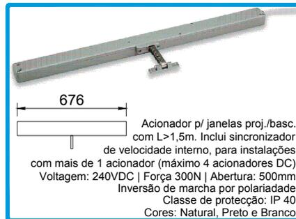
212648 ACIONADOR ELÉTRICO SINCRON. 24VDC
