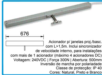
212648 ACIONADOR ELÉTRICO SINCRON. 24VDC
