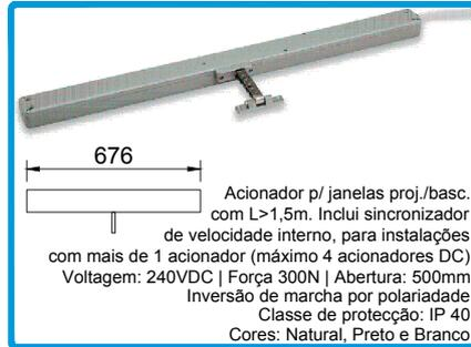
212648 ACIONADOR ELÉTRICO SINCRON. 24VDC
