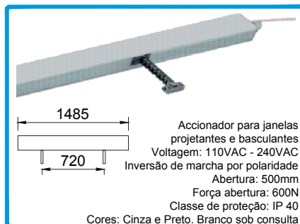
Acionador para janelas projetantes e basculantes Voltagem: 110VAC - 240VAC Inversão de marcha por polaridade Abertura: 500mm Força abertura: 600N Classe de proteção: IP 40 Cores: Cinza e Preto. Branco sob consulta
