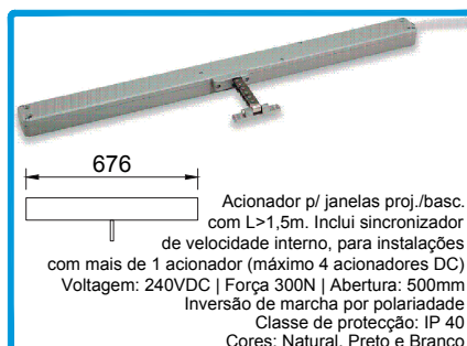
Acionador p/ janelas proj./basc. com L>1,5m. Inclui sincronizador de velocidade interno, para instalações com mais de 1 acionador (máximo 4 acionadores DC) Voltagem: 240VDC | Força 300N | Abertura: 500mm Inversão de marcha por polaridade Classe de proteção: IP 40 Cores: Natural, Preto e Branco
