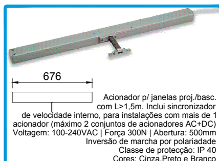
Acionador p/ janelas proj./basc. com L>1,5m. Inclui sincronizador de velocidade interno, para instalações com mais de 1 acionador (máximo 2 conjuntos de acionadores AC+DC) Voltagem: 100-240VAC | Força 300N | Abertura: 500mm Inversão de marcha por polaridade Classe de proteção: IP 40 Cores: Cinza, Preto e Branco
