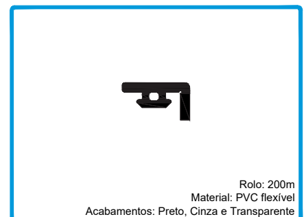
208090 JUNTA VD 2204 Rolo: 200m Material: PVC flexível Acabamentos: Preto, Cinza e Transparente
