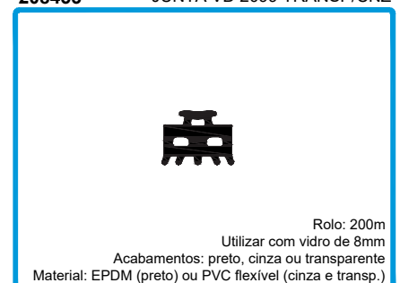
208438 JUNTA VD 2118 Rolo: 200m Utilizar com vidro de 8mm Acabamentos: preto, cinza ou transparente Material: EPDM (preto) ou PVC flexível (cinza e transp.)
