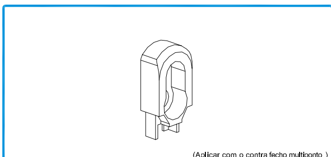
215060 PEÇA ANTI-LEVANTAMENTO MULTIPONTO (Aplicar com o contra fecho multiponto )
