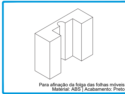
Para posicionamento das Ferragens Multiponto ALU, SOS e SOT, nos sistemas JL e JT Material: ABS | Acabamento: Preto 211007 GABARITO POSICION. MULTIP. JT
