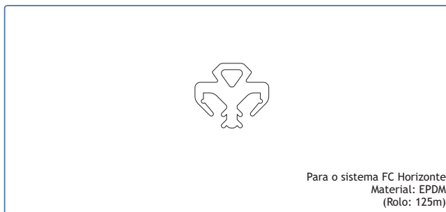
208476 JUNTA EXTERIOR 2007 Para o sistema FC Horizonte Material: EPDM (Rolo: 125m)
