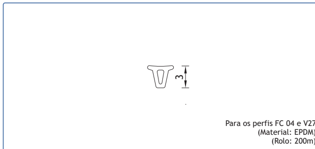
208288 JUNTA EXTERIOR 2141 Para os perfis FC 04 e V27 (Material: EPDM) (Rolo: 200m)
