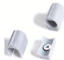
Colocar em cada metro uma presilha. Colocar no início e final de curvas
